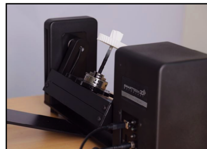
Pełny automatyczny skan 3D dzięki zastosowaniu stolika uchylno-obrotowego
