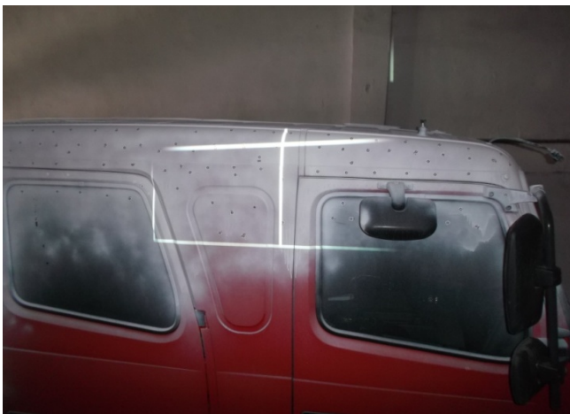
Rys. 2. Obiekt pokryty preparatem antyrefleksyjnym i markerami pozycjonującymi.
