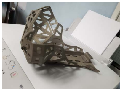
Prototyp wykonany w technologii druku 3D
