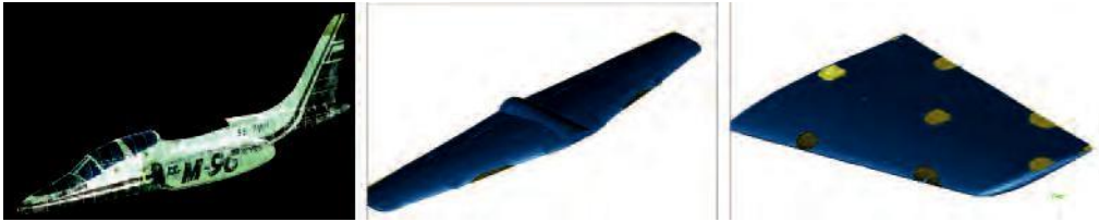
Rys. 7. Rezultat procesu skanowania w postaci globalnych chmur punktów: kadłuba, skrzydła, statecznika poziomego
