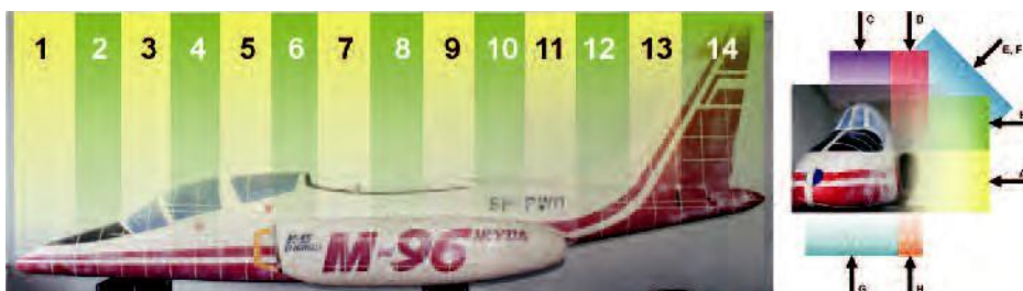
Rys. 3. Podział kadłuba samolotu na sekcje pomiarowe: a) wzdłuż kadłuba 1-14, b) poprzecznie do kadłuba a-f
