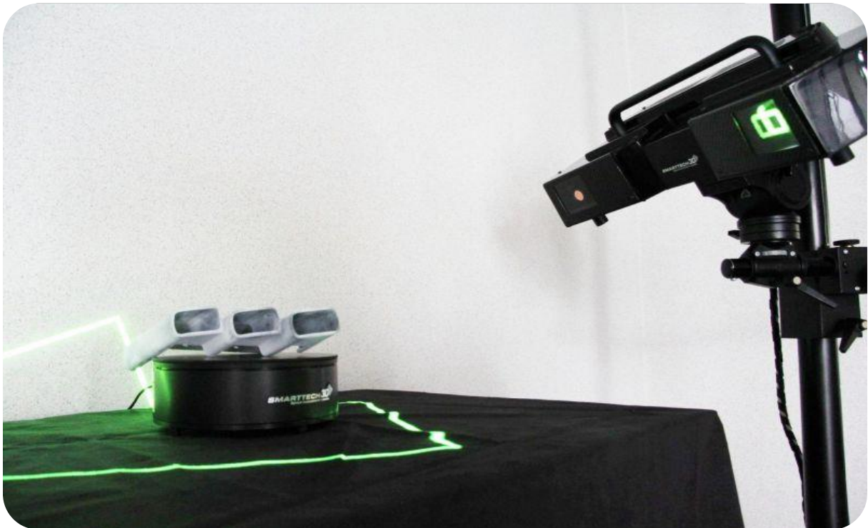
Rys. 3. Skaner MICRON3D green w trakcie pomiaru mocowań
