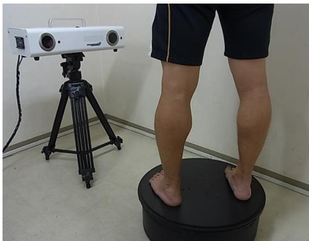
Rys. 1. Skanowanie 3D z użyciem stolika obrotowego.
