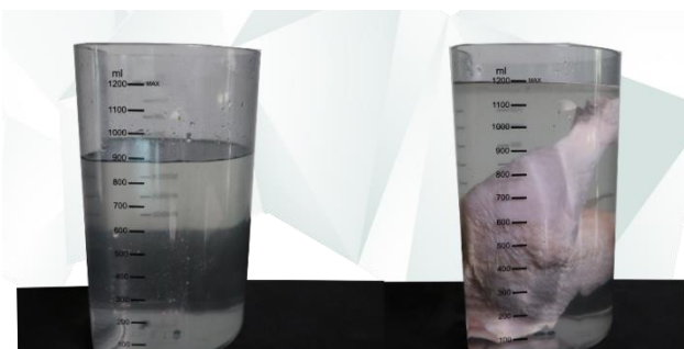
Wyznaczanie objętości obiektu na podstawie zmiany wysokości słupa cieczy
