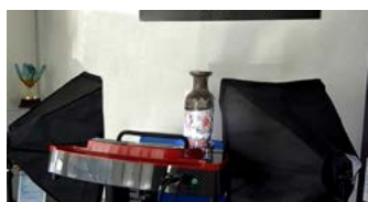
Proces skanowania 3D z użyciem systemu bezcieniowego
