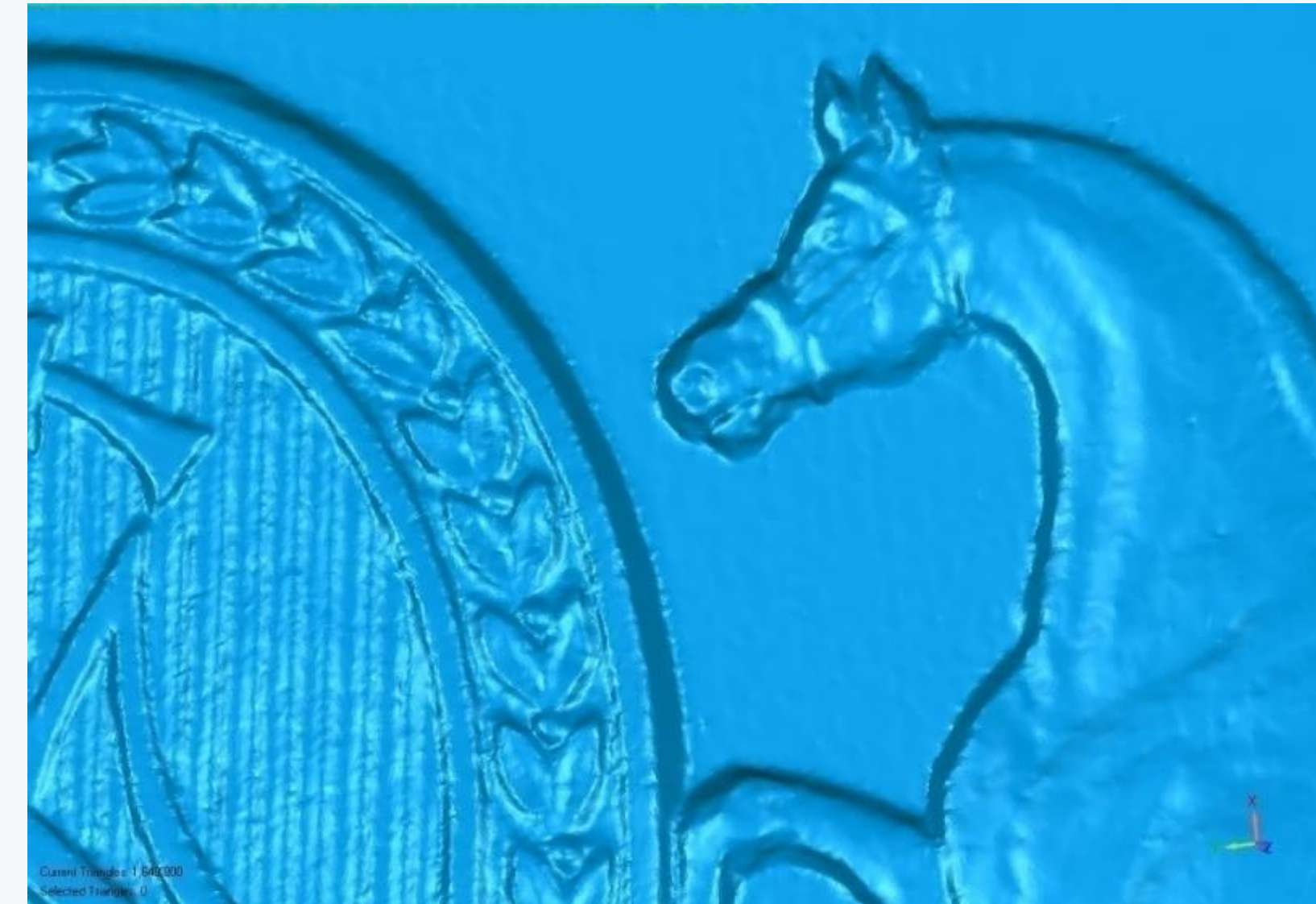
Wyniki skanowania skanerem 3D o rozdzielczości 18MPix, dokładność odwzorowania 0,05mm.
