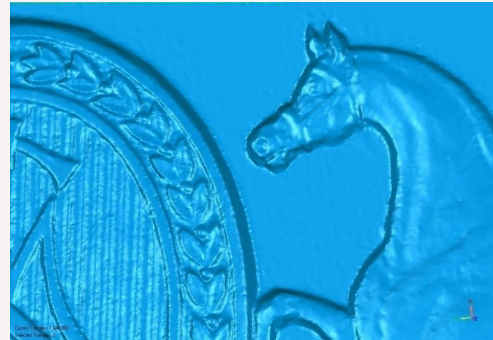
Wyniki skanowania skanerem 3D o rozdzielczości 18MPix, dokładność odwzorowania 0,05mm.
