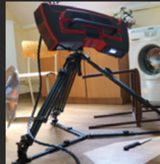
Dokładny skan 3D narzędzia zbrodni - chmura punktów o gęstości 900 pkt/mm 2
