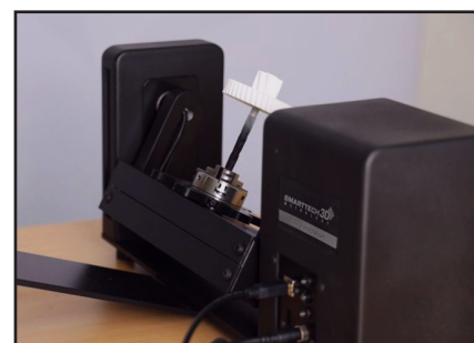
Pełny automatyczny skan 3D dzięki zastosowaniu stolika uchylno-obrotowego
