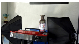
Proces skanowania 3D z użyciem systemu bezcieniowego
