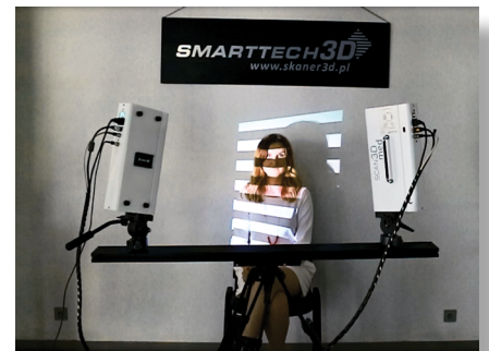
Zintegrowany system 2 skanerów 3D pozwalający na jednoczesny pomiar z wielu kierunków
