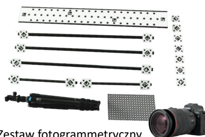
Zestaw fotogrammetryczny do pomiaru dużych obiektów
